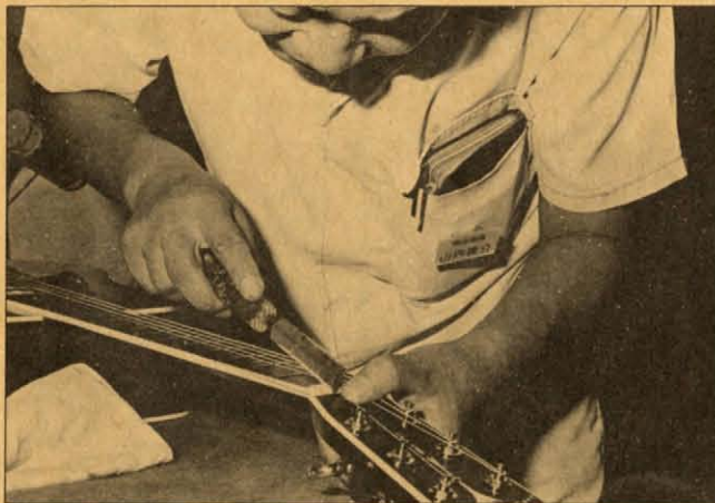
▲完成品：調律、音色、外観のチェック。弦高の調整などが行われます。
