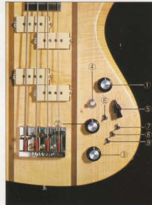
①マスターボリューム ②プースターボリューム ③トーンコントロール ④P.U.セレクターSW ⑤6ポジションロータリーSW ⑥プースターSW ⑦フェイスSW ⑧デュアルサウンドSW(フロントP.U.) ⑨デュアルサウンドSW(リアP.U.)
