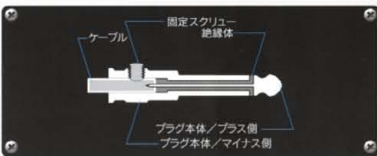
※固定スクリームはプラグの側面に絡み合うように、メカロックされています。
