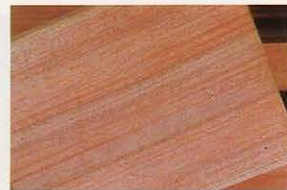
運び抜いた原木を使用し、ボディ材として製材してからさらに選別して使用される高品質のマホガニー材。乾燥、シーズニングをグレコ独自の基準で行ない、音響的に最適な状態に仕上げてからボディに加工する。
