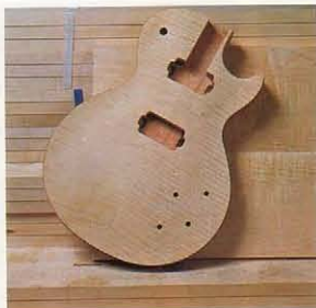
カナダ現地で選別し直輸入している、堅く、木目の締まったメイプル材。現地での自然乾燥、人工乾燥、そして工場での自然乾燥、人工乾燥により含水率を楽器として最適な5~6%まで落して加工している。
