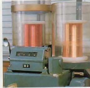
グレコ研究開発部門には専用の試作工程ラインがある。ボディ用の工作機から、数々のコイル、ピックアップのコイルワイナードまで全て揃え、充分に納得の行くまでサウンドのグレードアップを行なっていく。
