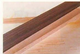
充分にアーク抜きを行ない、自然乾燥、人工乾燥、二次乾燥を経て初めにネックにセットするローズウッド指板材。しっくりと指先なじみ技師のタッチを生み出すグレコ独自の乾燥基準を設けて管理を行っている。
