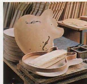
メイプル、マホガニー、メイプルの三層構造を持たせたスーパーリアルセミアコースティックボディである。トップ、バック、センターブロック&サイドリムの接着には細心の注意をはらって工程を進めて行く。
