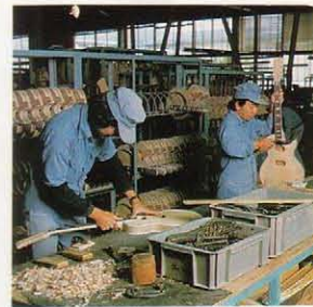
ボディとネックを連携するセットネック工程ラインを設けているEGFモデル。半完成のギターがやっとキターらしくそのスタイルを整える部門だ。一本一本確実にセットし、クランプで固定して行く。
