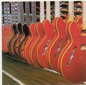
塗装をはじめとする全てのセクションは極めて厳重な品質管理、行程管理の元に行なわれている。塗装セクションはチリ、ホコリなどを完全にシャットアウトした2重のカーテン、エアカーテンで仕切っている。
