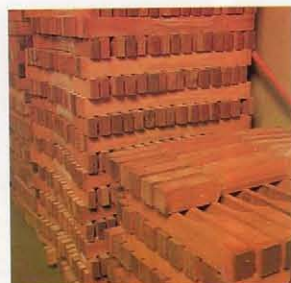
グレコでは原木を工場内で製材し、木目の通っている最高の材質のみをネック材として使用している。自然乾燥、人工乾燥、荒加工、二次乾燥、シーズニングなど長い歳月をかけてはじめてネックとして加工に入る。
