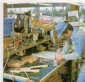
研究開発部門での作業はそのほとんどが手作業によって行われる。ボディの微妙なシェイプ、ネックのアルなど実にデリケートなカーブは絶対にマシンでは出せないからだ。ここでのデータが製品に反映される。
