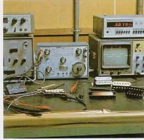
研究開発部門におけるピックアップのチェック。測定はサウンドをオシロシ高いものにするために必要不可欠なものだ。いくつものピックアップ測定、データを作成し、ピックアップのグレードアップを図っている。
