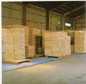
メイプル材、アルダー材、セン材、マホガニー材などグレコのあらゆるモデルのボディ材がこうにして加工されボディとなるのを待っている。整然とレイアウトしてある屋内は通風性、通気性に満ちている。
