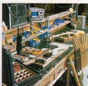
最終チェック工程で製作されたギター。ベースは全てチェックを受ける。ネック調整、サット調整、弦高調整、オクターブ調整、サウンドチェックなどが行われ、これにパスしたものがグレコとして世に出る。
