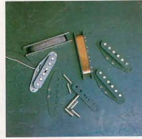
研究開発のために試作したいくつものピックアップ。コイルを変え、磁力を変え、マグネット材を変え、ポイントを変えて、いくつものデータを作成し、この後、多くのプロフェッショナルにヒアリングされる。
