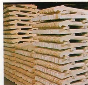
メイプルネック材はカナダより直輸入したハードメイプル材を使用。現地での自然乾燥、人工乾燥、工場での自然乾燥、人工乾燥を繰り返す。完成後の後工程でシーズニングを行い、狂いの無い安定したネックとしている。
