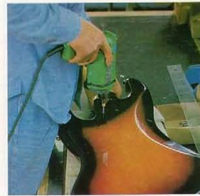
ネック工程、ボディ工程と別々に流れていたディタッチャブルラインを1つにまとめるネックセット工程。熟練したクラフツマンカー本一本ボディ、ネックの具合を確かめながら作業を行い、ネックを固定して行く。
