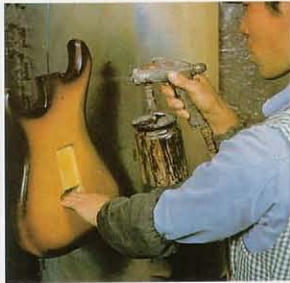
ディタッチャブルモデルの塗装は素材の特徴を生かした技術が用いられる。アルダーボディ、センボディなどボディ材による木目の出かた、フィニッシュの違いなど、厳しいチェック、管理の後、はじめてパスとなる。
