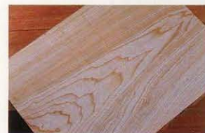
寒冷地で育った木目の良く引き締まっている良質のセン材をボディ材として使用。自然乾燥、人工乾燥、シーズニングを経て最適な含水率に仕上げているこれらのボディ材は、素晴らしい響きを約束してくれる。
