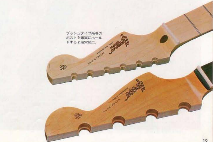
極めつけのフレームグレイメイプルネック材。厳しい条件下に育った稀少価値のフレームグレイメイプル材をネック材として加工した、グレコだからこそ成し得た最高のネックといえる。(SE1200に使用)
