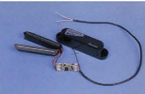
◆RG1003.1000にマウントされているL-0-25ピックアップは、フィードバックによるイーストマンセリシタを行なった後、ハイパスフィルターを使用したアクティブ回路へ信号が送られます。もちろん、すべてピックアップの内蔵で。
