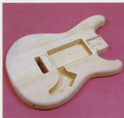
◆トーンチェインバー加工はピックガードの下に大きなサウインド・ホールを開けることで、鳴りと共振、そしてごく繊細な残響を与えてくれます。
