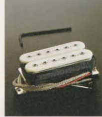
アルミシールドのDSUハムバッキングピックアップ
