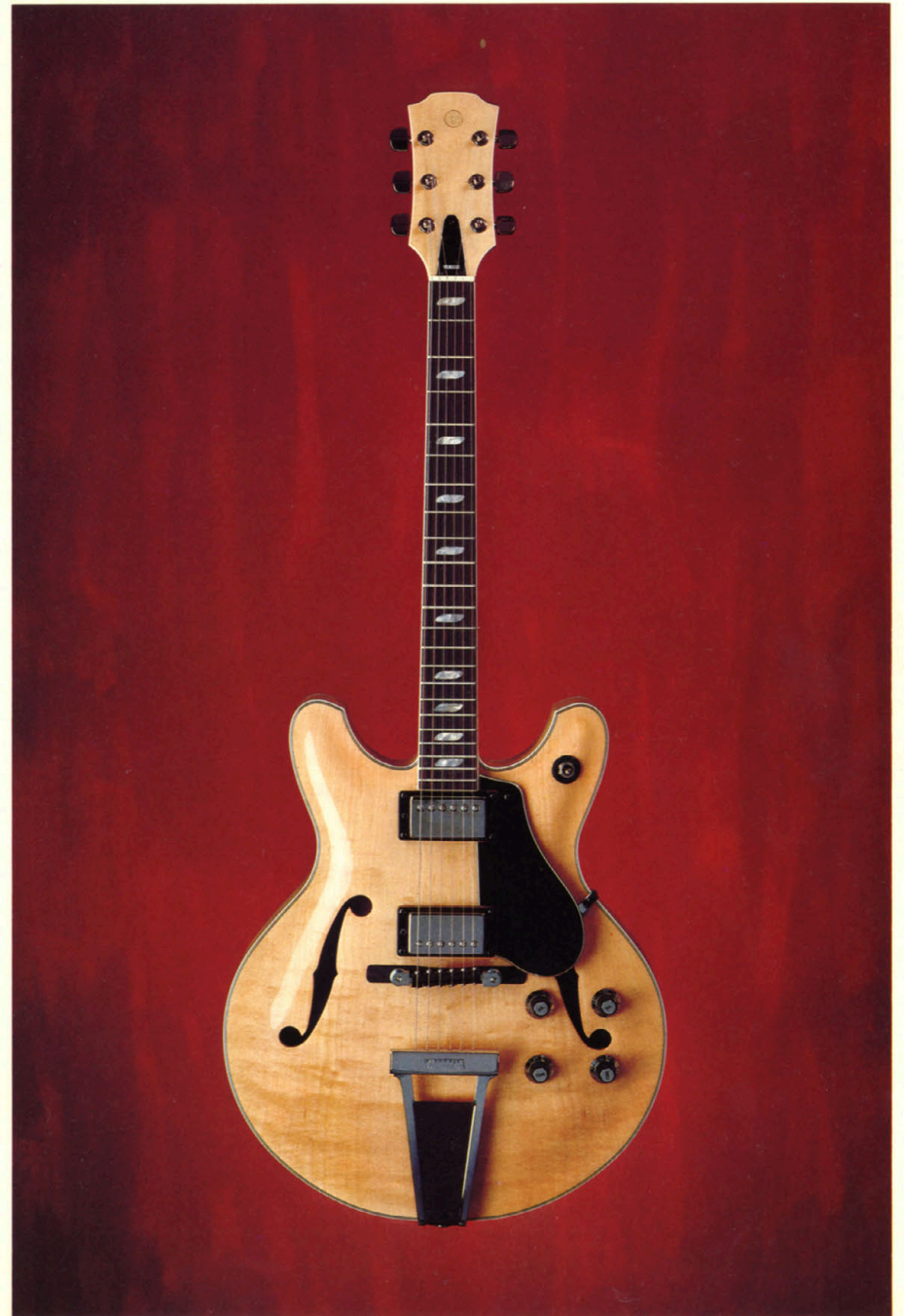
SA-60(セミアコースティックギター)・・・¥65,000○6弦(ヤマハH1020)○22フレット○2マイク ○ピッチ・弦高調整付ブリッジ○高級ダイカスト糸巻(クロームメッキ仕上)○全長=1041mm○全巾=403mm○胴=カエデ ○棹=カエデ○指板=ローズウッド○重量=3.8kg○色=サンバースト/ナチュラル
