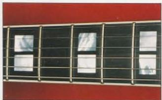
オーバーバインディングフレット——フレットを有効長ぎりぎりまで延長。1弦、6弦の弦落ちを防止。チョーキング奏法、ビブラート奏法をより確実にした。(オーバーバインディングフレット: SA全機種、白蝶貝2ポイント・ポジションマーク SA-2000)
