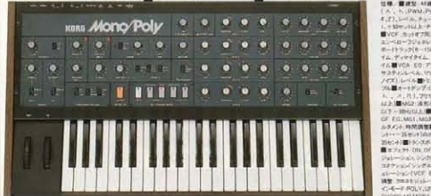
4VCOにシンクロ、X-MODなどのエフェクトを装備。強烈な音づくりのできるリードシンセ。
