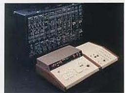
●フラット：8チャンネルコントロール電圧(0V-10.56V、127ステップ、83mV/step)をチャンネルゲート出力、並列チャンネルのMPX出力、CV1プログラムによりオシメイトON/OFF可能システム700用DINコネクタ出力端子付 ●インプット：シンキーインプット、外部キーボードによるリアルタイムインプット ●クロック：最大M.M.L.=284(312sec.-10ms/1step) ●メモリ容量：標準4KByte オプション追加より最大16KByte(約1200音標準-5300音最大)ただしV1層及びSeptime Gatesのみ ●使用IC：6800A(CPU)、5KByte PROM、4KByte-16KByte RAM ●外形寸法：本体440(W)×155(H)×406(D)mm、インターフェース303(W)×114(H)×405(D)mm ●重量：本体11kg、インターフェース4.5kg ●消費電力：60W
