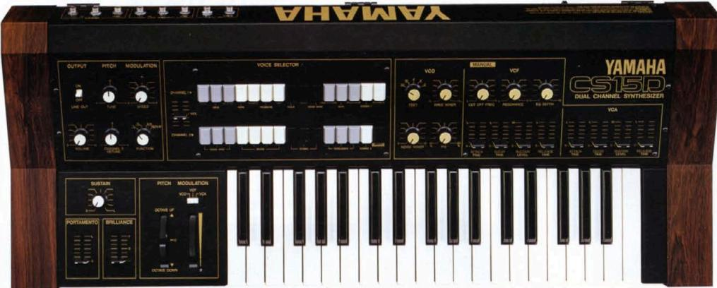
リアルタイムの演奏で、なるべくたくさんのサウンドバリエーションが欲しい。しかもシンセサイザー本来の自由度の高い機能欲しい……。キーボーダーの切実なニーズに応える、ライブパフォーマンス専用シンセサイザ―CS-15D。プリセットサウンドは2チャンネルのボイスセレクターに分けて装備。チャンネル1とチャンネル2を組合せることで、従来のプリセットタイプでは決して得られない、幅広いサウンドバリエーションが得られます。もちろんシンセサイザー本来のVCO、VCF、VCA、EG、LFOを駆使したサウンドづくりは、少しも損われていません。さらにライブパフォーマンスの充実を計るに、マニアックコンローラー群の操作性も、いちから向上させた設計です。
