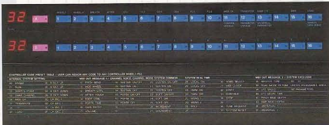
上：プログラムセクター、16プログラム×2バンクの2バンクモードと、16プログラム×8の8バンクモードが切り換えられます。下：16進法によるコントローラーコードテーブル。00～3Fの2717には、エフェクトからMIDI信号まで64種類をプリセット。40～FFはユーザーズエリアです。
